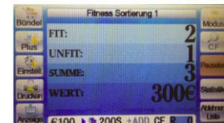
Die vier verschiedenen Programme sortieren die Banknoten nach vorgegebenen Einstellungen. Im Fitness 1-Modus wird nach allen EZB-Bestimmungen sortiert. Alle Scheine, die der Definition entsprechen, gelangen ins Ausgabefach, die Restlichen in das Rückweisungsfach
