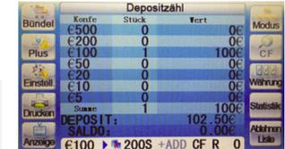
Die Maschinen überprüft die Richtigkeit des vom Kunden angegebenen Geldwerts. Falls die Banknoten erfolgreich erkannt werden, gelangen sie in das Ausgabefach. Alle nicht erkannten, oder bei aktivierter Echtheitsprüfung, alle verdächtigen Scheine werden im Rückweisungsfach ausgegeben.
