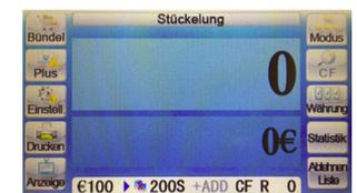
Die Maschine sortiert verschiedene Stückelungen nach Wert und Anzahl. Die als unterstes eingelegte Banknote bestimmt die Stückelung, die im Ausgabefach ausgegeben wird. Die übrigen Stückelungen landen alle im Rückweisungsfach. Echtheitsprüfung ein- und ausschaltbar.
