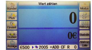
Die Maschine zählt und erkennt die jeweiligen Banknoten und zählt die Anzahl (obere Anzeige) und den Wert (untere Anzeige). Falls die Banknoten erfolgreich sortiert werden, werden sie im Ausgabefach ausgegeben. Die Echtheitsprüfung kann hinzugeschaltet werden, so dass alle Banknoten, die nicht zweifelsfrei erkannten oder als verdächtig eingestuft werden, im Rückweisungsfach ausgegeben werden. Echtheitsprüfung ein- und ausschaltbar.
